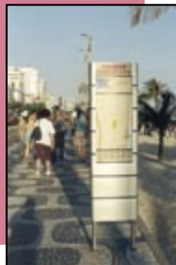
Figura 203 – Placa de indicação de parada de transporte coletivo instalada afastada do meio-fio. Recomenda-se que o mobiliário esteja próximo ao meio-fio, deixando o restante do espaço livre para circulação. As informações devem ser disponibilizadas em braile também.
