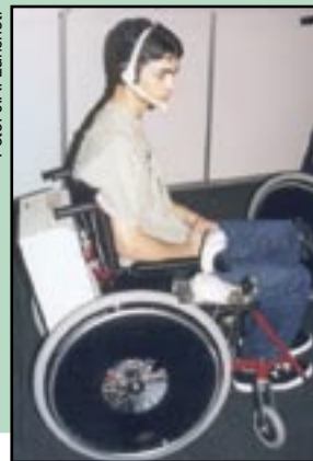
Figura 130 - Cadeira de rodas acionada por comando de voz do seu condutor.
