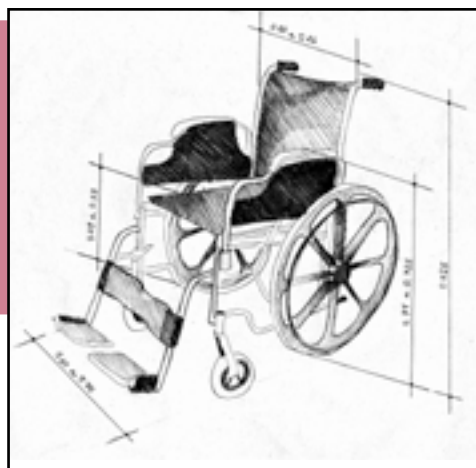
Figura 176 – Referências das dimensões de cadeira de rodas para projetos, conforme NBR-9.050:2004.
