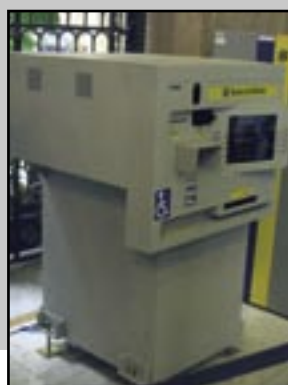
Figura 148 – Caixa Eletrônico com indicação do símbolo de acessibilidade, com os comandos em alturas indicadas para pessoas em cadeiras de rodas, porém com vários comandos visuais e ausência de sons que possibilitem sua utilização por pessoas com problemas de visão.
