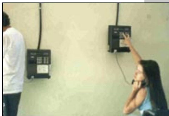
Figura 049 – A imagem demonstra a usuária de cadeira de rodas precisando esticar ao máximo seu corpo para poder acessar o ponto mais alto do telefone público.
