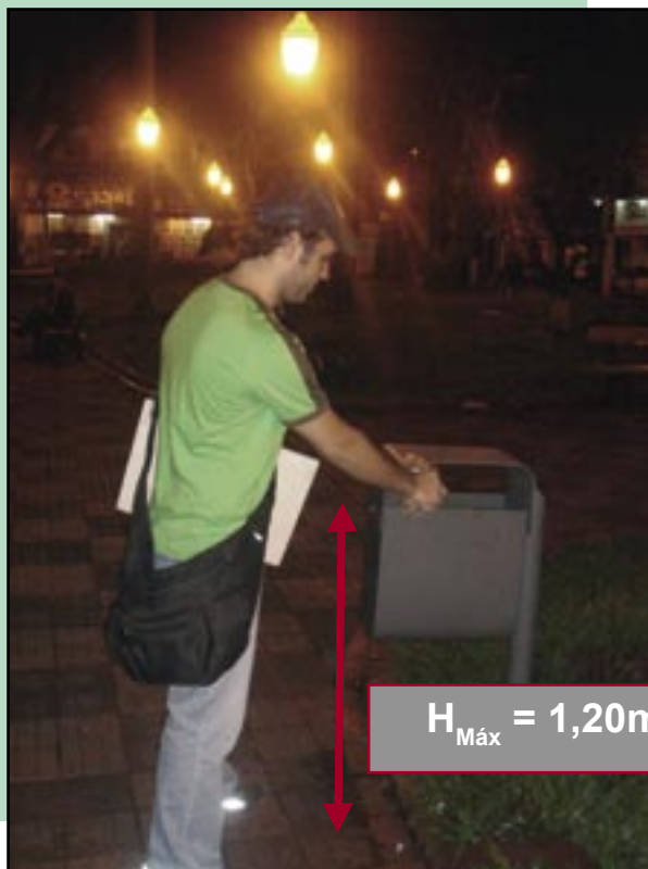
Figura 218 – Recipiente coletor de resíduos sólidos (lixeira) instalada em altura respeitando a NBR 9050:2004 para a utilização de pessoas em pé ou em cadeiras de rodas.
