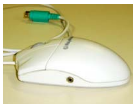
Figura 13 – Mouse adaptado com plug
