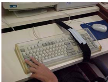
Figura 5 - Máscara de teclado encaixada no mesmo
