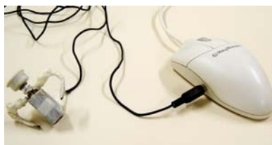
Figura 14 – Acionador confeccionado com botão liga/desliga de computador
