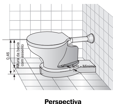
Figura 38 – Adequação de altura de bacia
