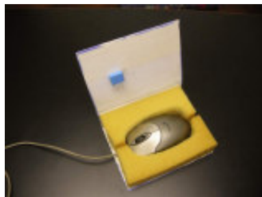
Mouse convencional transformado em acionador artesanal
