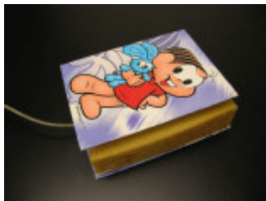
Mouse convencional transformado em acionador artesanal
