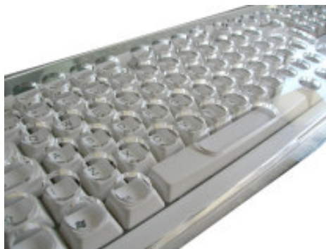
Teclado com colméia de acrílico
