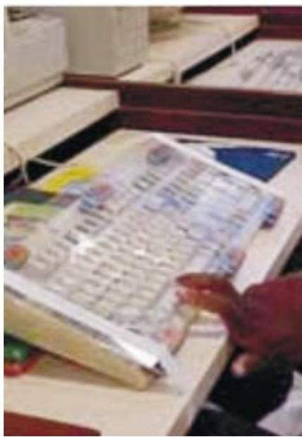
Foto 12 - Teclado com alteração na inclinação e fixado à mesa
